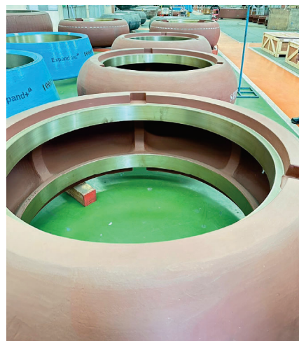
ผลิตภัณฑ์ชิ้นส่วนหม้อบดแนวตั้ง สายการผลิตชิ้นส่วนหม้อบดแนวตั้ง (สายการผลิตที่ 4)
